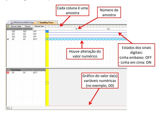
Para exibir o gráfico no momento do trigger, clique com o botão direito do mouse sobre o gráfico e selecione "Result Position" > "Move to Trigger Point";
