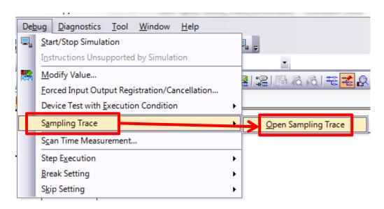
d) Após o passo acima, aparece uma aba "Sampling Trace" no GX Works2 como a ilustrada abaixo. As caixas de texto abaixo explicam cada parte da janela do Trace;
