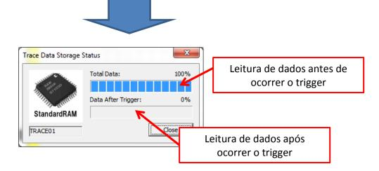
n) Observe no status do Trace (como abaixo, em destaque), o estado do Trace. Se aparecer a mensagem "Before trigger", o trigger está sendo aguardado. Se aparecer "Execution Failed" repita o passo "m" novamente e certifique-se que a CPU está em RUN.
